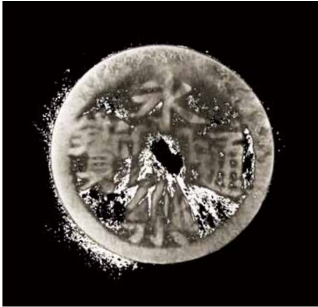
写真8 さし銭のX線CT画像 画像提供 東北大学総合学術博物館
