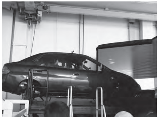
乗車中の車から、避難する訓練ができるシミュレーター
