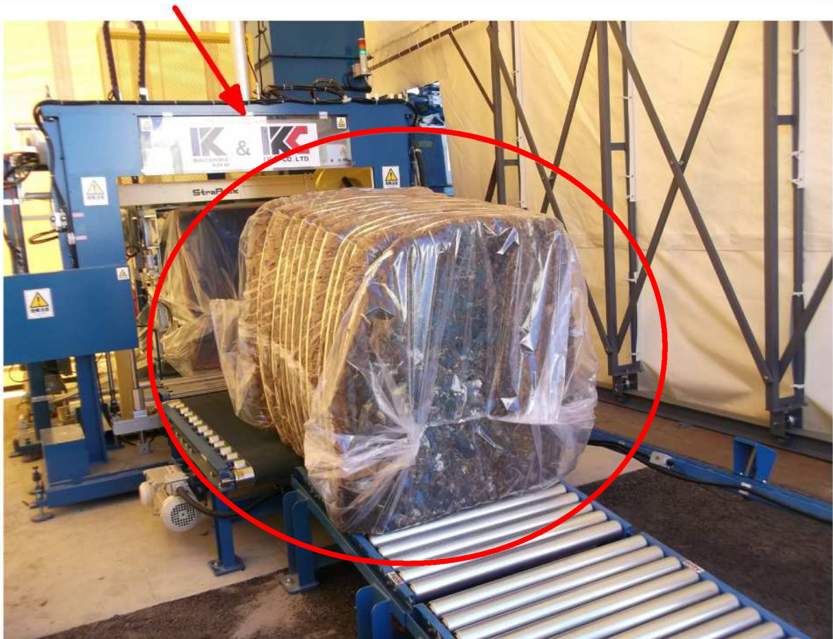
自走式シュレッダで破碎された後、圧縮梱包機から、粗大系可燃物の圧縮梱包材
